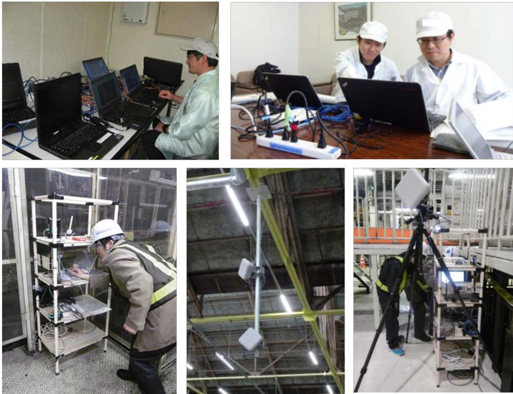
図1 NICTと共同実験各社が、複数の稼働中の工場で行った無線環境評価、無線通信実験の様子
