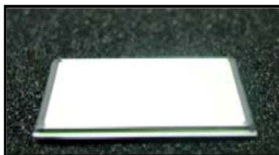
[ご参考] Chip-on-Chip MCM ( X 線検出用デバイス [ 上部 ] と、検出信号 処理用 CMOS デバイス [ 下部に 4 ケ ] )
